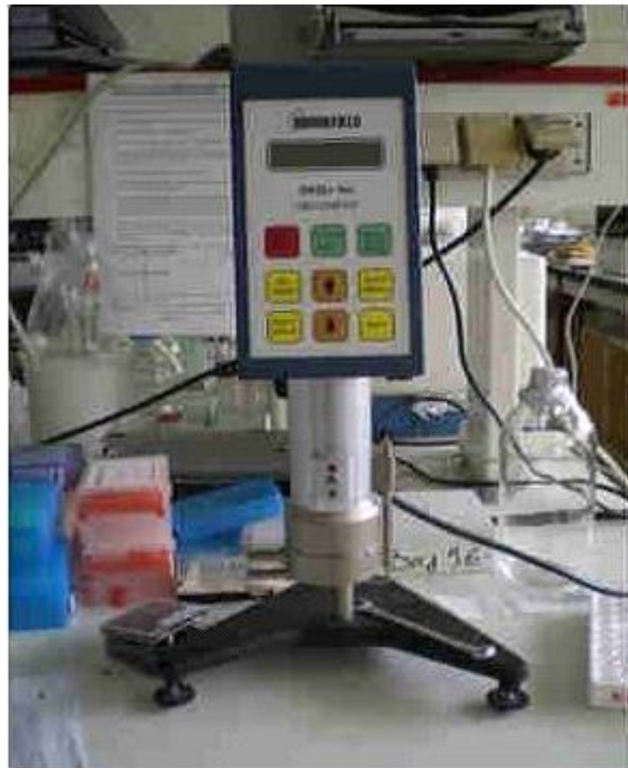
Figure 9 : Viscosimètre cône-plan Brookfield, modèle LVDV-II+PRO
