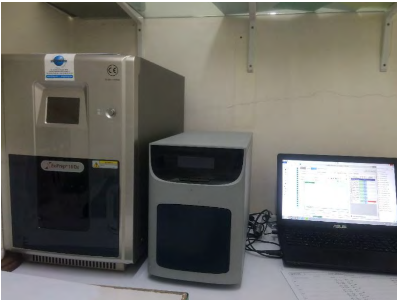
Figure 163: Extracteur automatique, le système informatique de pilotage (AMPLIX) et le thermocycleur
