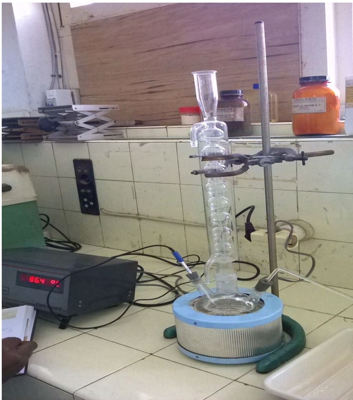
Figure 5: Montage réalisé pour la détermination de la température d'ébullition.
