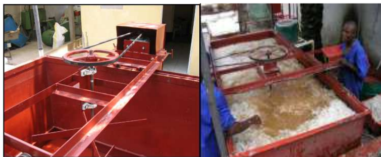
Figure 8. Cuve de lavage avec un malaxeur pour brassage
