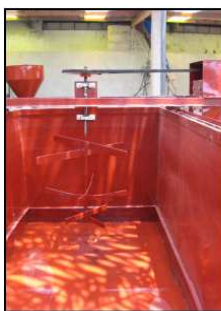
Figure 8. Cuve de lavage avec un malaxeur pour brassage
