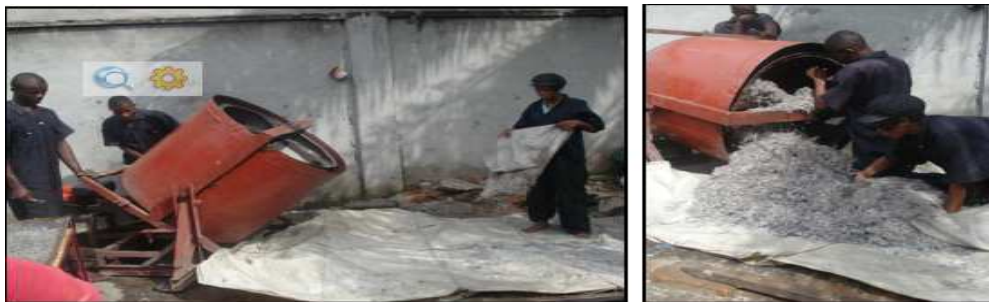
Figure 13. Une essoreuse équipée d'un tambour qui peut basculer après essorage pour faciliter les opérations de vidage des plastiques est beaucoup plus productive.
