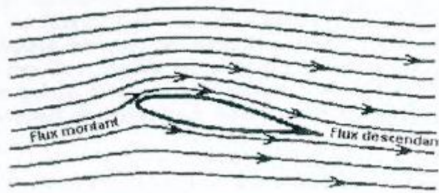
Figure 32 : Flux d'air circulé aux niveaux des ailes de l'avion
