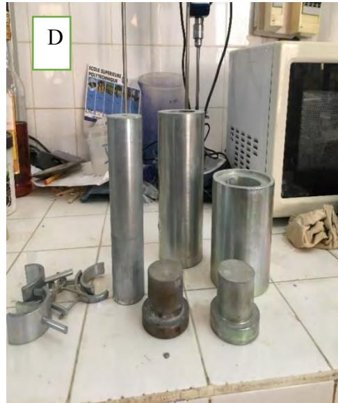
C : moule utilisé pour l'essai d'aptitude et D : moule utilisé pour l'essai de compression
