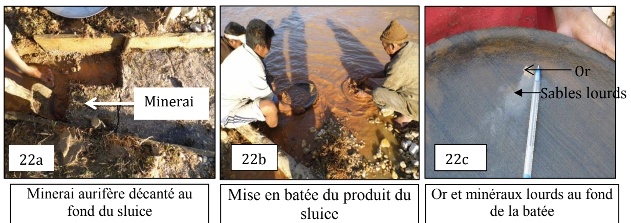
Figure 22: Etape de la mise en batée du minerai
