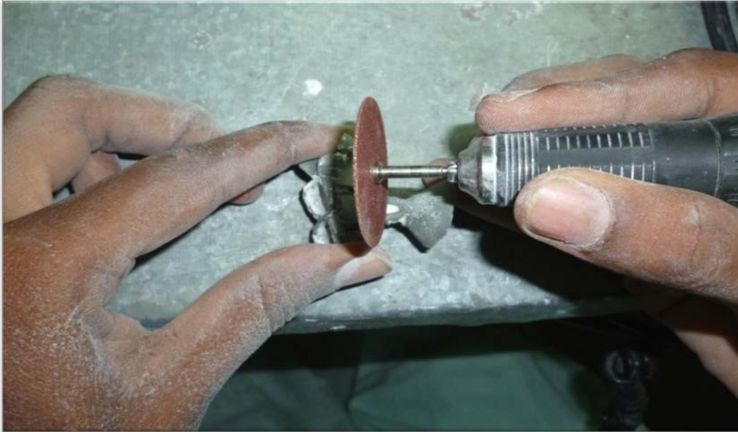
Figure 26 : Section des tiges de coulée
