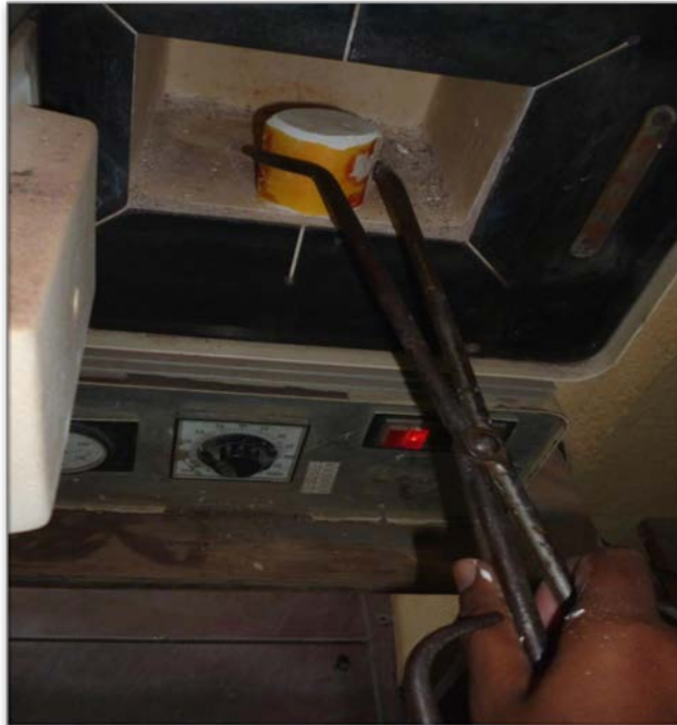
Figure 22 : Enfournage du cylindre
