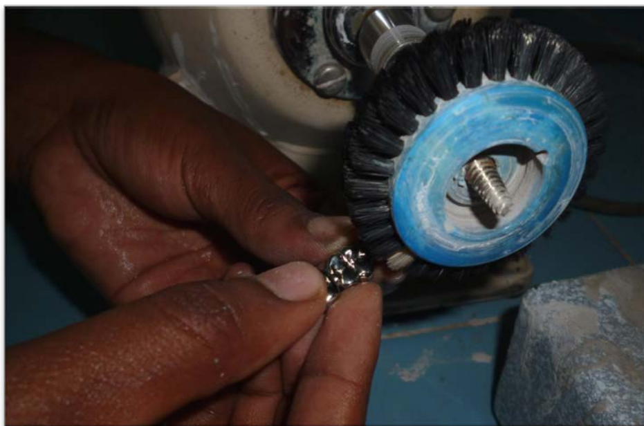
Figure 28: Polissage du bridge métallique
