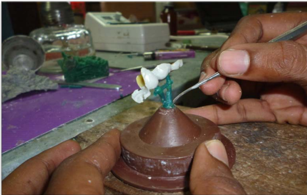
Figure 19 : Pose tiges de coulée sur la maquette en cire
