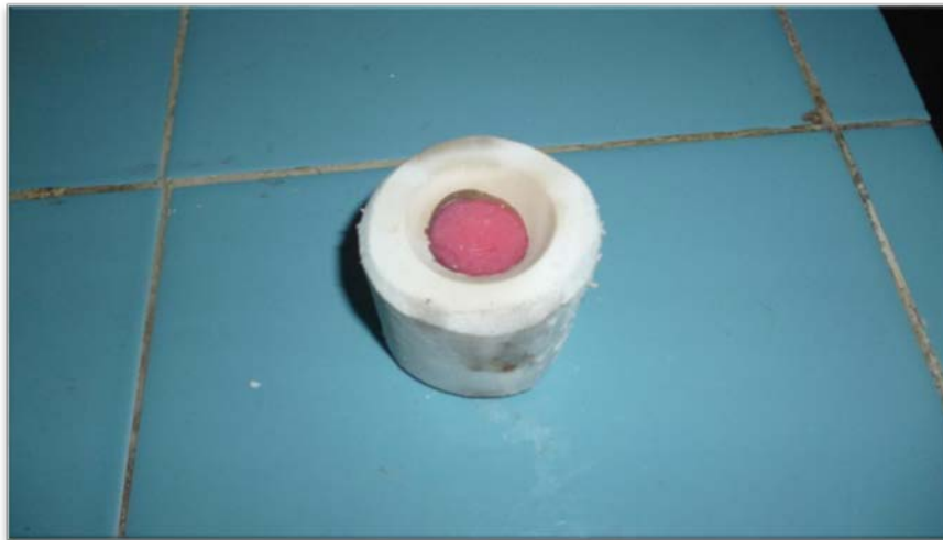
Figure 24 : Refroidissement du cylindre
