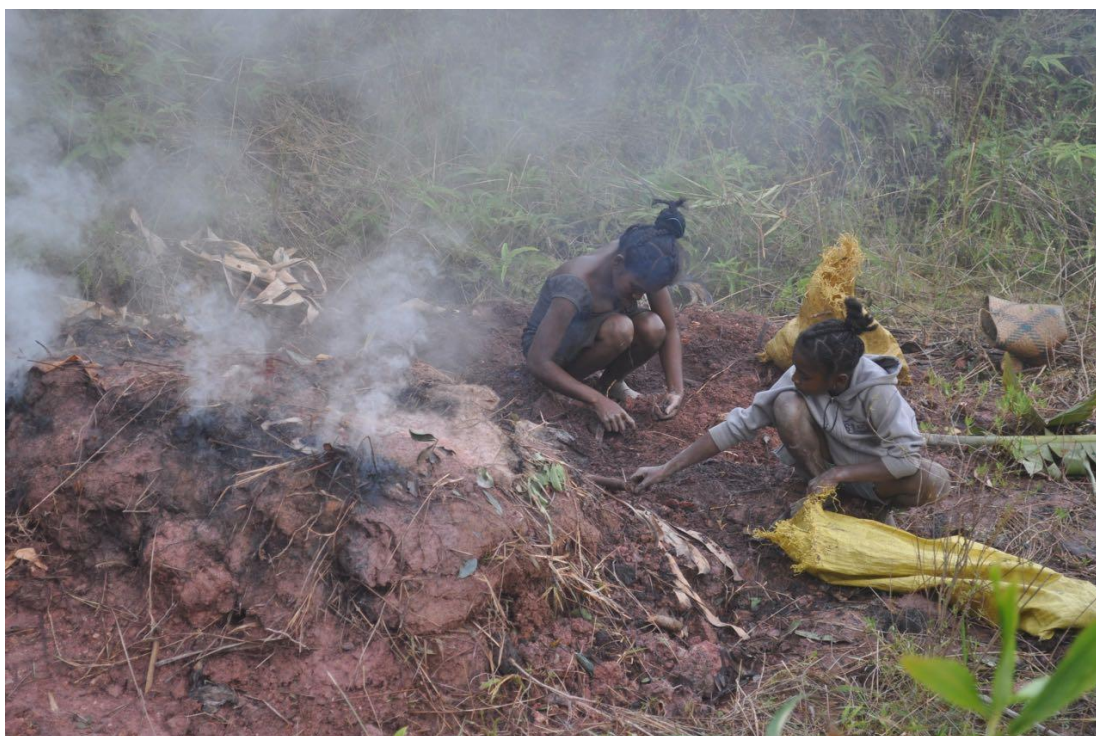
Photo 3 : Four à charbon de Grevillea banksii sur la route de Soanierana Ivongo (Kull, 2016).
