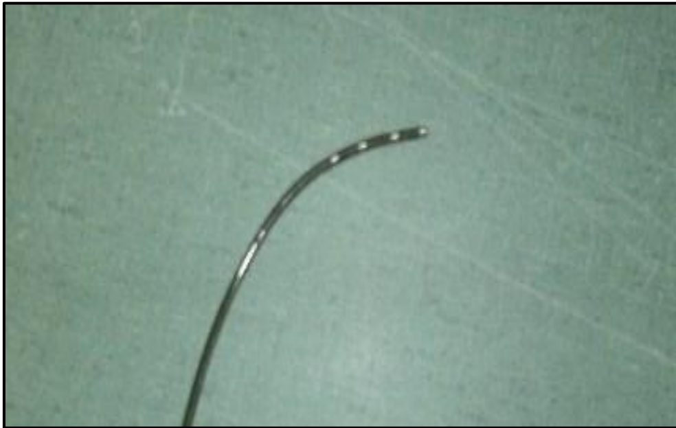
Figure 26 : Mise en évidence des quatre poles d'une sonde quadripolaire de notre laboratoire
