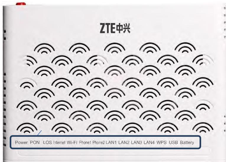
FIGURE 51 : AVANT DU MODEM ZTE
