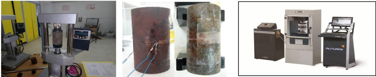
**Figure IV.2.** Échantillon de massif rocheux avec jauges de contrainte.
