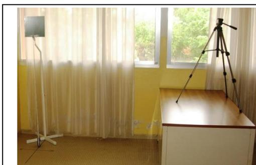
*Figure 7 : Miroir carré montée sur une tige métallique coulissante supportant l'échelle métrique ; et trépied support de l'appareil photographique dans un milieu bien éclairé*
