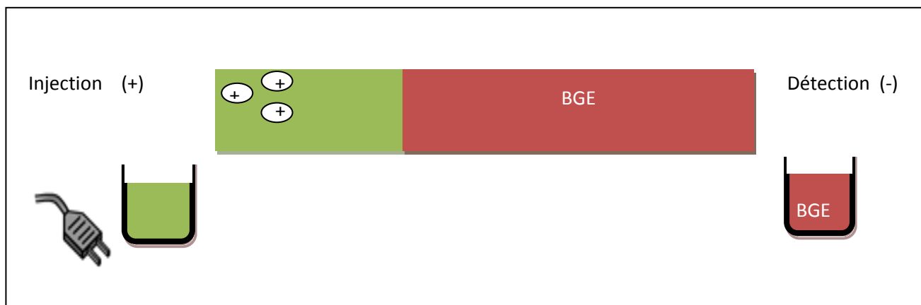
Figure 13 : Principe de l'injection électrocinétique
