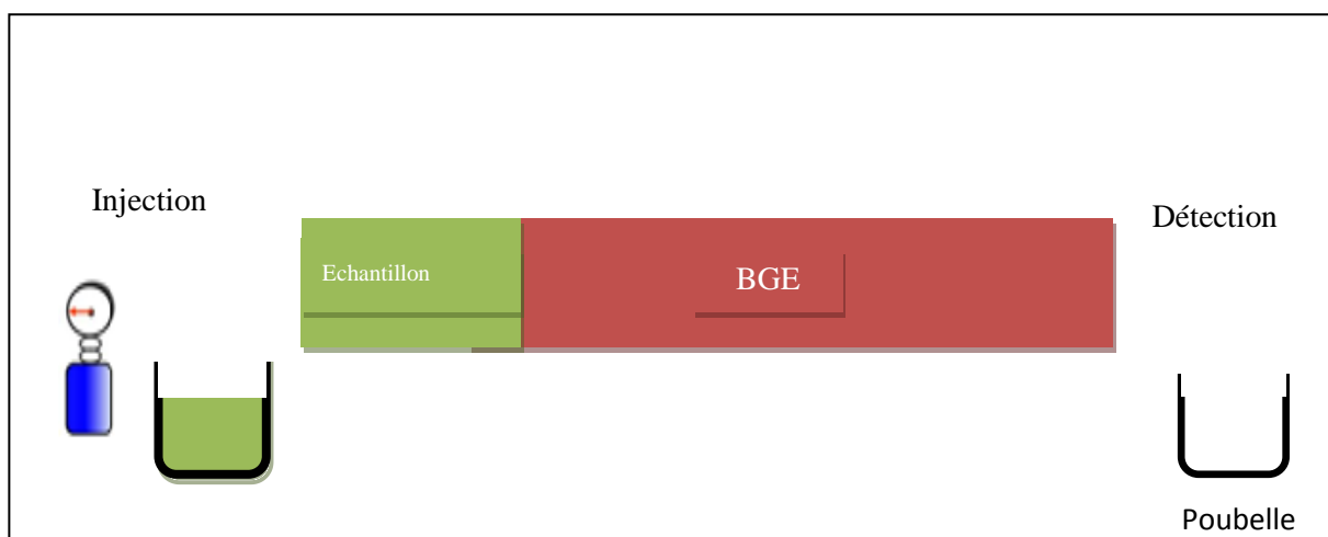
Figure 12 : Principe de l'injection hydrodynamique
