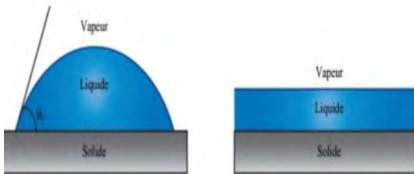
FIGURE 3 Les deux états de mouillage : mouillage partiel / mouillage complet
