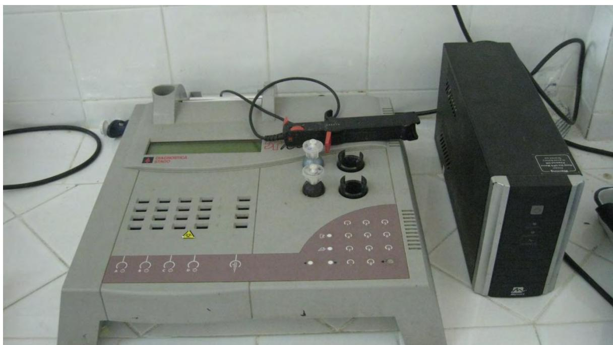
**Figure 3: Le coagulomètre (Start)**
