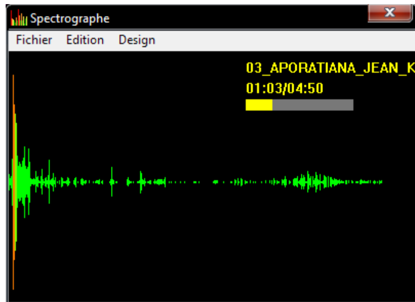
Figure 4.12 : lecteur de fichier wav, mp3 et wma avec visualisation spectrale
