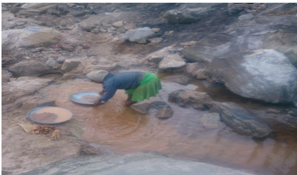
Photo 14 : Lavage du minerais aurifère par batée
