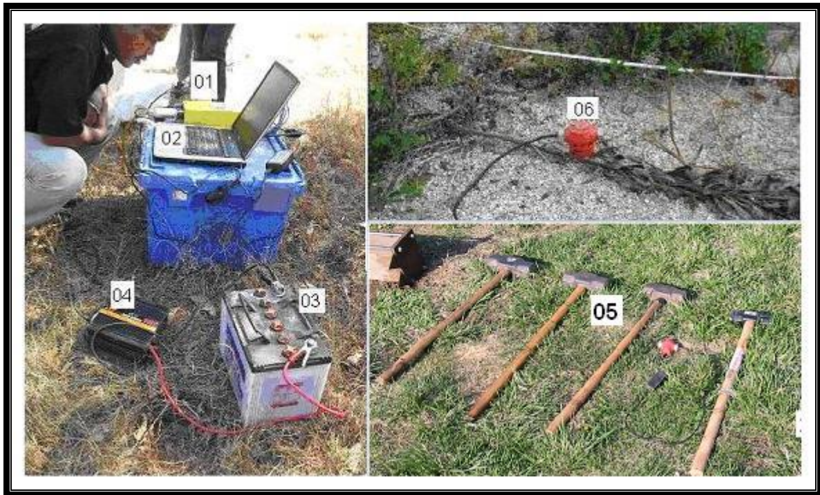
Photo 5: Schéma du montage d'appareil de mesure en sismique (source impétrant , 2010)
