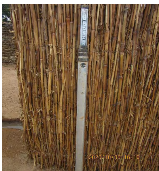
Photo 3: Perche emboitable pour la mesure de la hauteur des arbres des quatre accessions de Tamarindus indica L. en plantation à Daga Birame/Kaffrine
