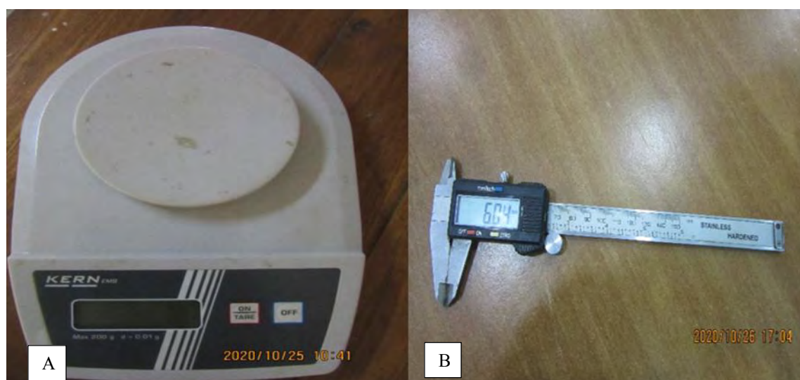
Planche de photos 5: Instruments de mesures des fruits de quatre accessions de Tamarindus indica L. : (A) = Balance à précision 0,01g, (B) = Pied à coulisse
