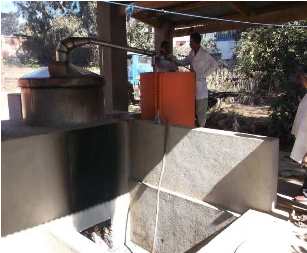
Figure 23: Cliché de l'alambic de grande capacité (200-300 kg de matière végétale)
