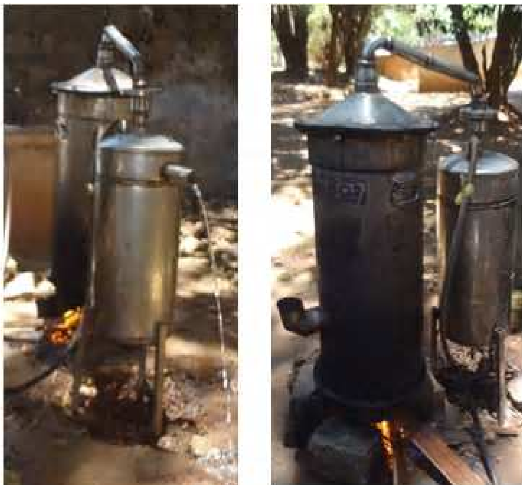
Figure 21: Cliché de l'alambic modifié
