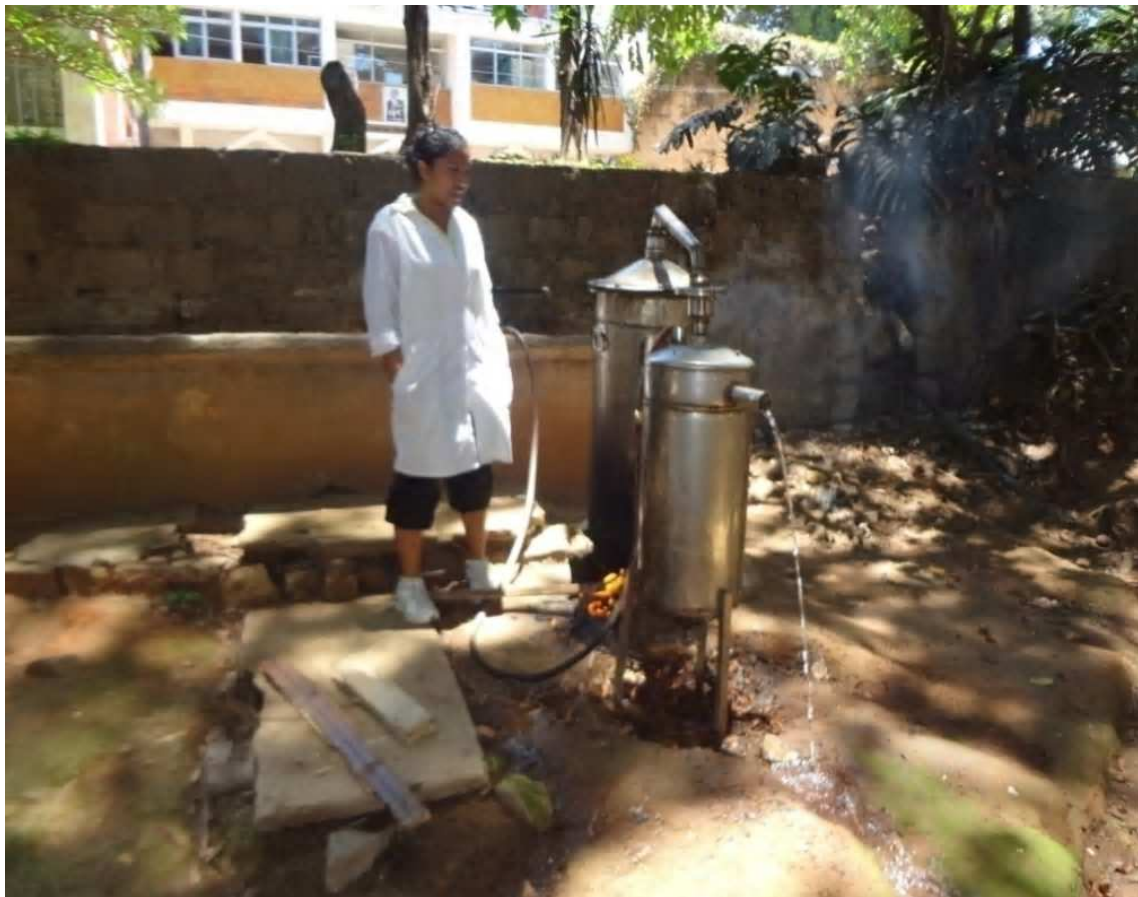
Figure 22: Cliché de l'alambic de petite capacité (6-10kg de matière végétale)
