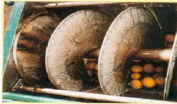
Figure 3: Principe de l'expression
