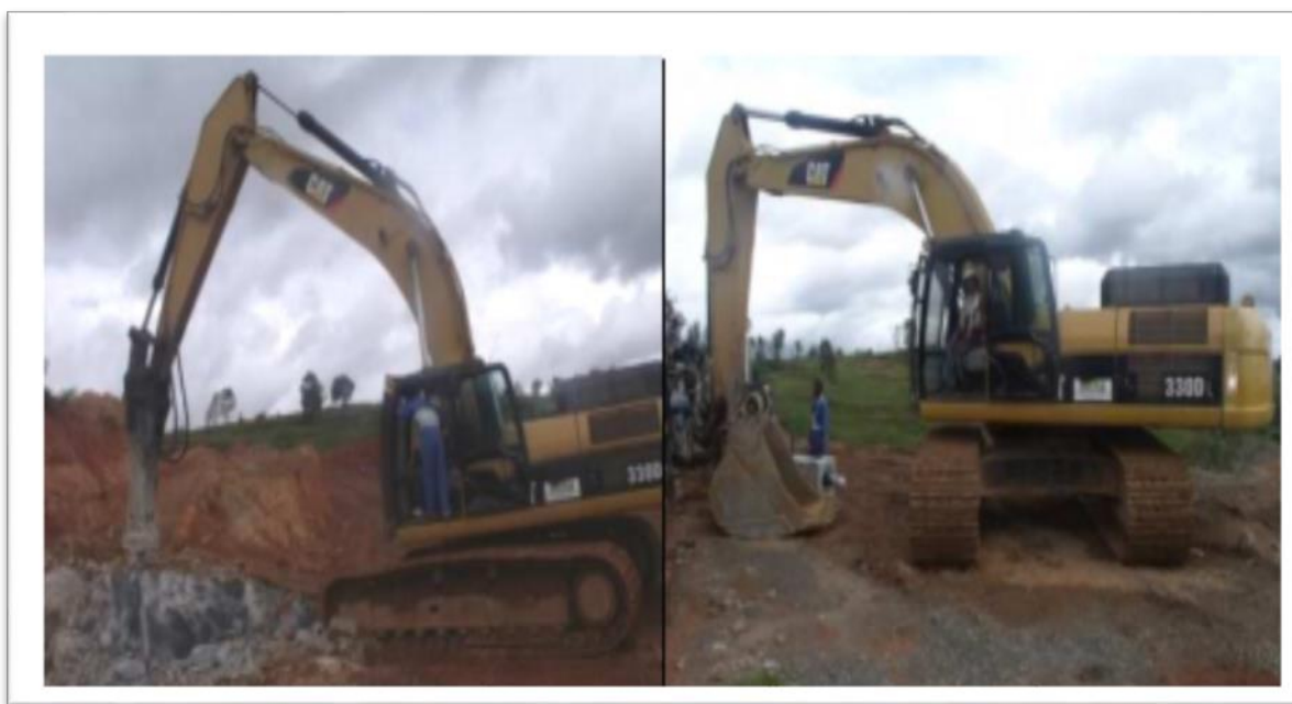
Photo 2 : Pelle mécanique 330DL en BRH et en chargeuse
