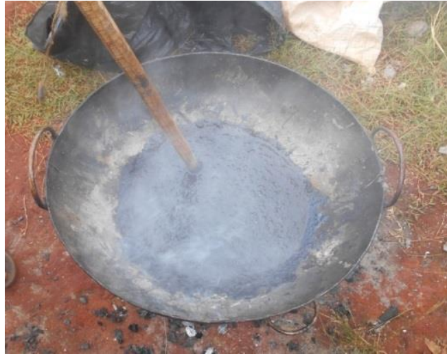
Photos 13 : le mélange de lapidairerie et du PET à presque 248°C
