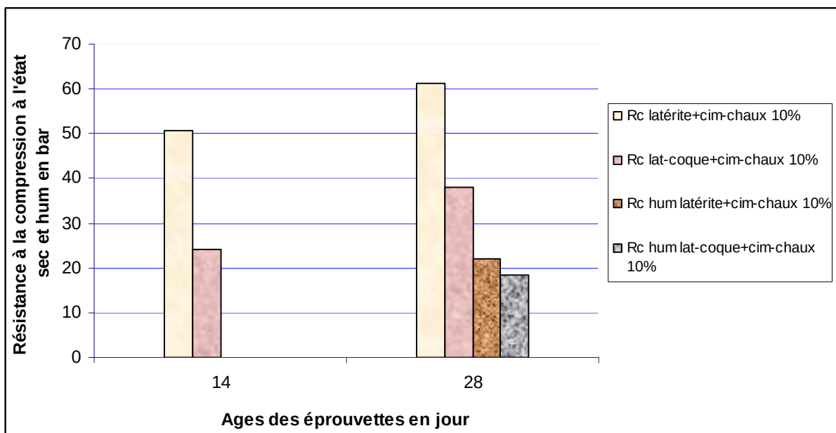
Diagramme 10: Résistance à la compression moyenne à l'état sec et à l'état humide des échantillons stabilisés par le ciment-chaux 10 %
