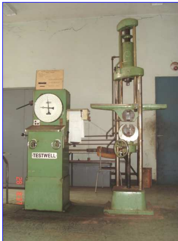
Figure 07: Appareil de mesure des résistances à la compression (Machine Testwell)
