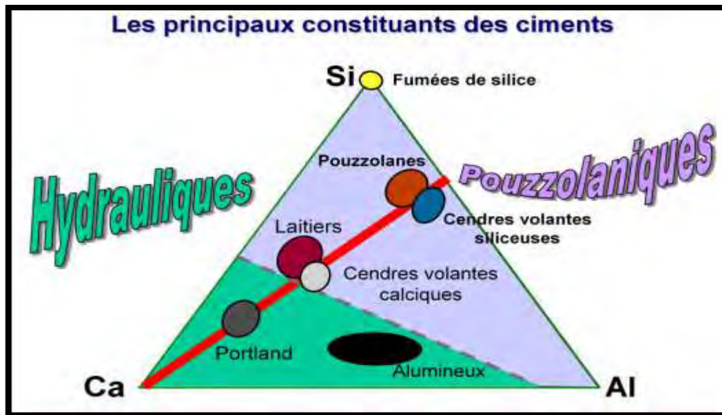
Figure 4 : composition des différents constituants du ciment dans un diagramme ternaire : silice-calcium-alumine. [HOLCIM Christophe charron,2008, p55]
