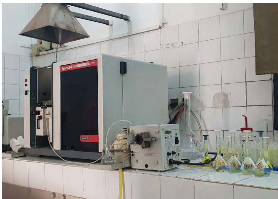
Figure 4 : Schéma du spectromètre d'absorption atomique (SAA) (Laboratoire de chimie CERES)
