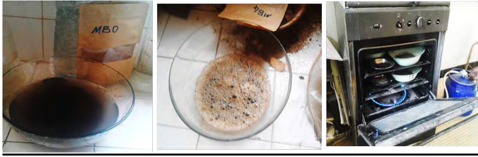
photo 8: détermination de la teneur en carbonate par attaque acide.
