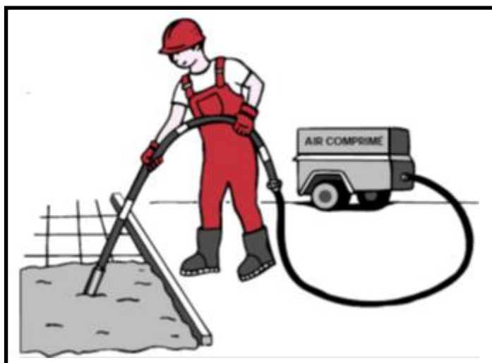
Figure 16: vibreur interne pneumatique
