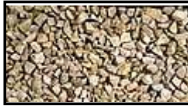
Figure 5 : Les graviers concassés
