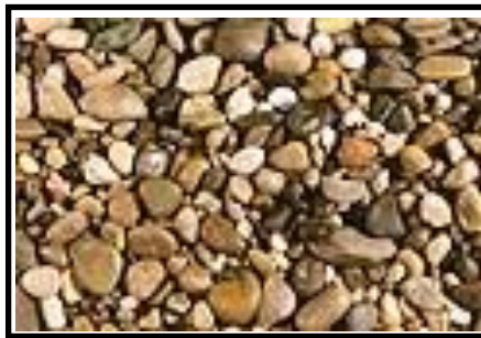
Figure 1: Granulats roulés de rivières
