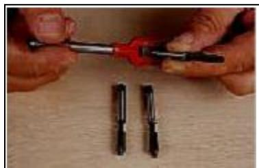
2. Placer le taraud ébaucheur (le plus conique) dans le tourne-gauche et le serrer fortement.
