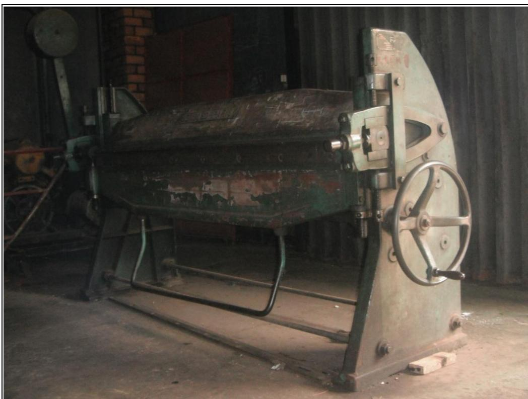
**Photo 12 :** Pliuse de tôle qu'on a utilisée
