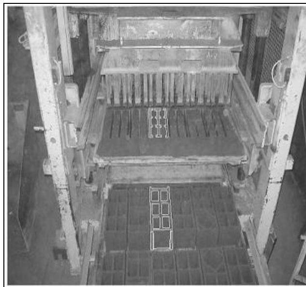
**Figure 8 :** Photo d'une presse vibrante lors de la sortie des produits
