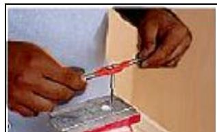
6. Changer l'ébaucheur pour le taraud intermédiaire et recommencer l'opération avec les mêmes précautions. Ne pas forcer le taraud dans l'empreinte précédente.
