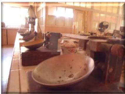
Photo 7 : Appareil de Casagrande
