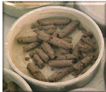
*Photo 12 : Détermination de la teneur en eau*
