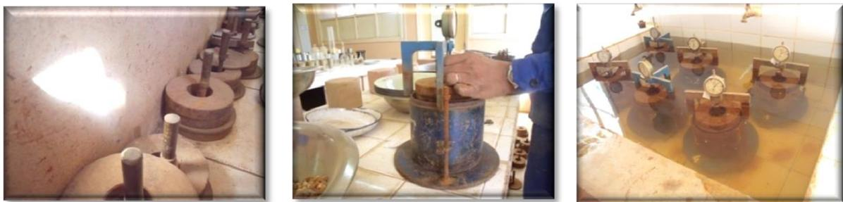
*Photo 20 : Anneaux de surcharge et plateau de gonflement, mise en place du comparateur et imbibition des moules*
