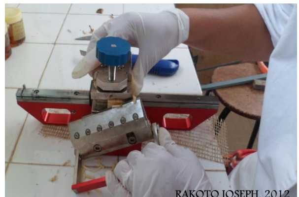
Photo 12: Réalisation de la coupe mince à l'aide du microtome G.S.L. 1
