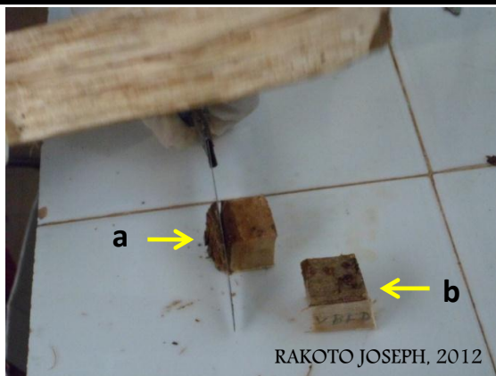
Photo 9: Cubes obtenus à partir d'une microcarotte (a)cube du bois ; (b) cube de la zone cambiale
