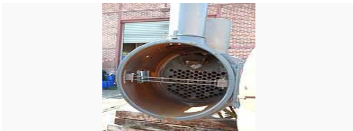
Photo2 : Chaudière tubulaire neuve destinée à la locomotive 030T n° 101 Pinguely du CFBS
