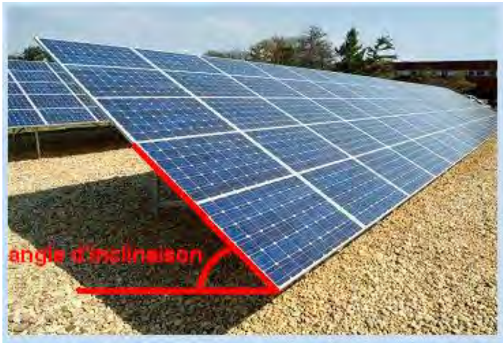
Figure 2-18: Angle d'inclinaison des panneaux solaires [42]
