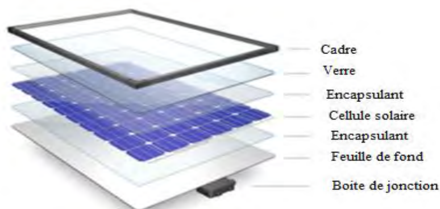
Figure 2-14: Structure d'un panneau photovoltaïque à base de silicium [39].
