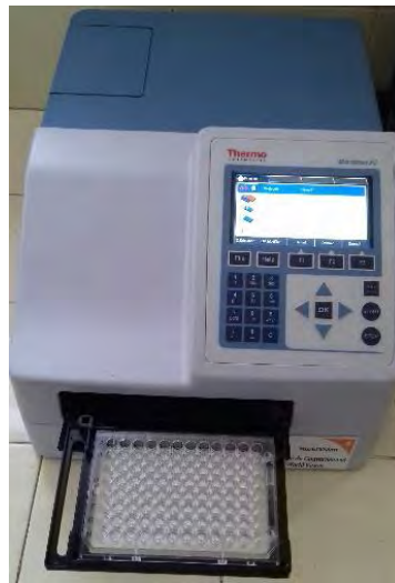
Figure 6: appareil pour les tests biochimiques, microplaques Multiskan™ FC (photo personnelle)
