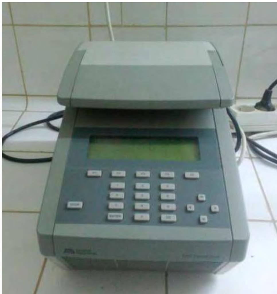
**Figure 6 : Thermocycleur pour l'amplification de l'ADN.**
