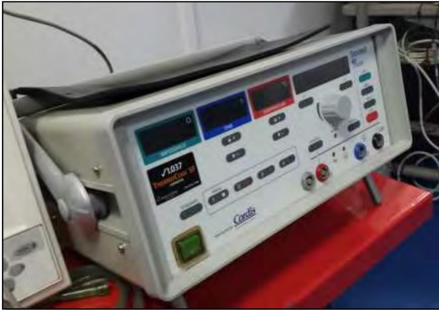
**Figure 37** : Générateur de RF. (Image de la salle de cathétérisme du service de cardiologie de l'hôpital Aristide Ledantec)
