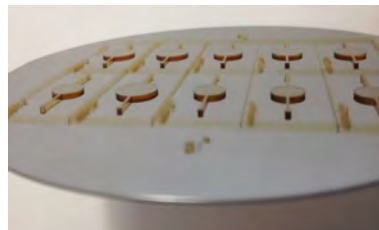
FIGURE 2.12 – Moule Si/SU8 des biopuces à optode
