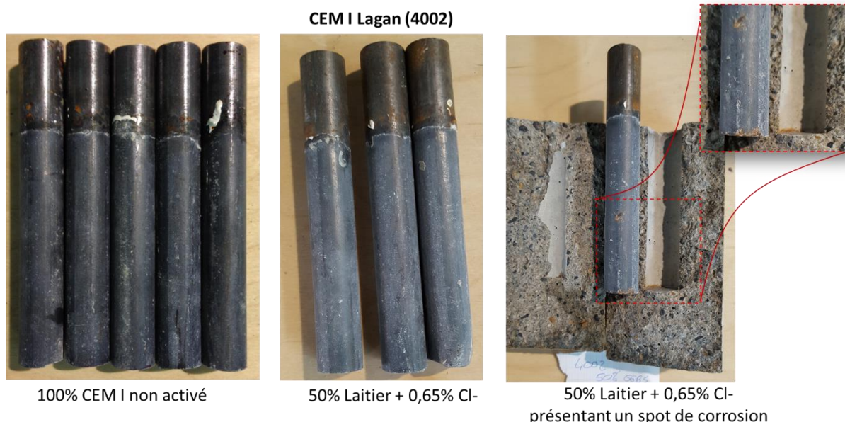
Figure 118 - Autopsies d'éprouvettes formulées avec CEM I Lagan (4002) avec 100% de ciment ou 50% de laitier activé avec 0,65% de Cl- dont l'une des armatures présente un spot de corrosion
