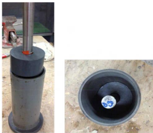
Figure 41 - Moules en PVC servant à la confection des éprouvettes électrochimiques [Sohail, 2013]
