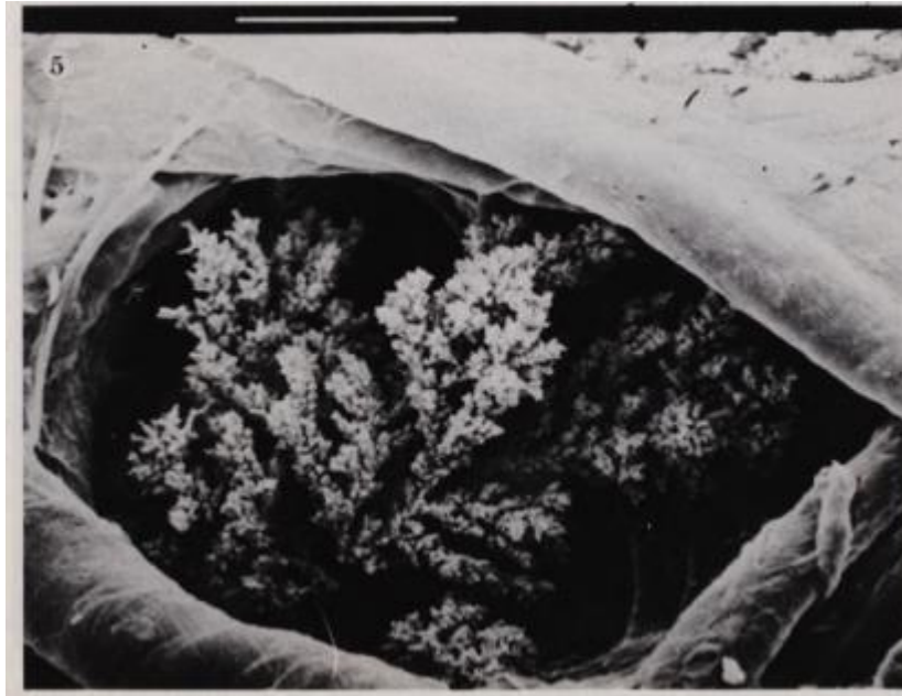
Figure I-32: Micrographie extraite de [48] d'un dépôt de cuivre réalisé sous une tension de 1 V, sur papier filtre, à partir d'une solution de 0,25 M de \text{CuSO}_4 et 1 M de \text{H}_2\text{SO}_4 .
