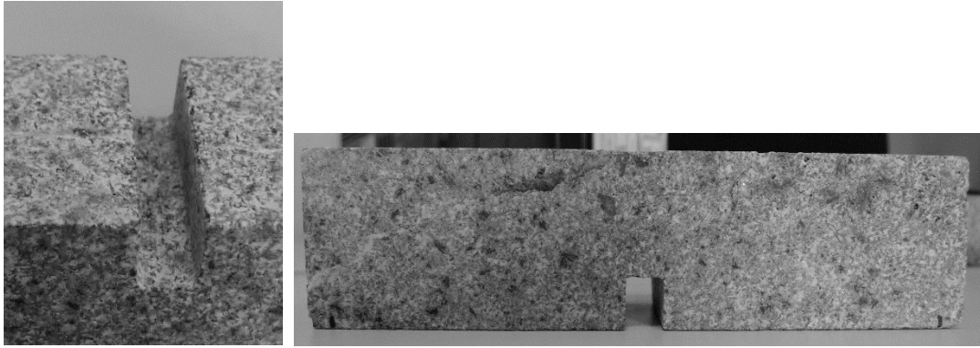
Figure 42 Entaille sur des échantillons en flexion
