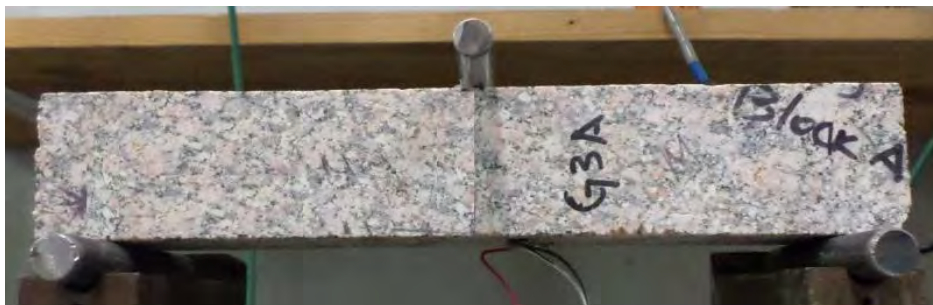
Figure 63 Disposition de l'essai en flexion
