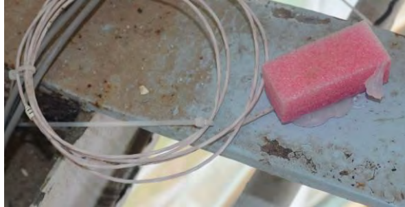
Figure 23 Capteur T11 en partie haute de la lanterne [20]
