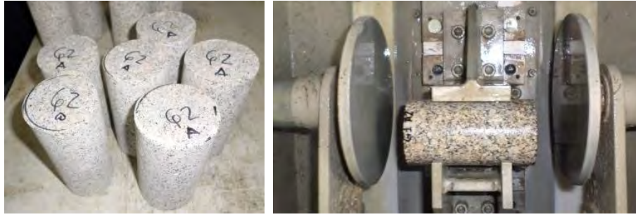
Figure 56 Préparation des éprouvettes cylindriques, carottage et rectification
