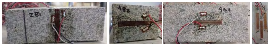
Figure 47 Jauges de mesure sur les échantillons de kersanton et échantillon de référence
