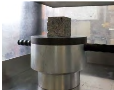
Figure 57 Cube du granite dans la presse d'essai en compression
