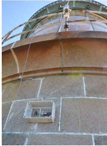
Figure 21 Anémomètre A2 et LVDT D6 sur la fissure du montant 8 – Photo CEREMA 13 septembre 2018
