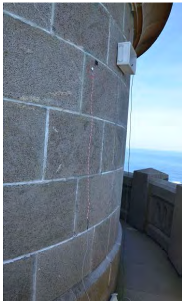
Figure 22 - LVDT D3, sondes T9 T10, vue du balcon périphérique - Photo CEREMA 11 avril 2017
