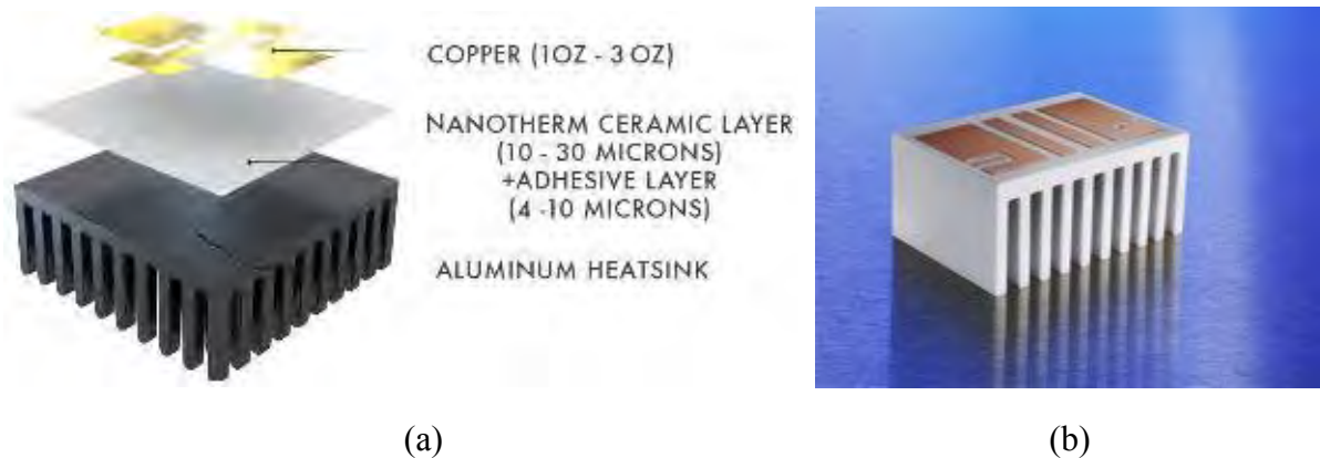
Figure 1.18 – Substrat IMS dissipateur ( Cambridge Nanotherm ) (a) et technologie CeramCool (b) ( CeramTec )
