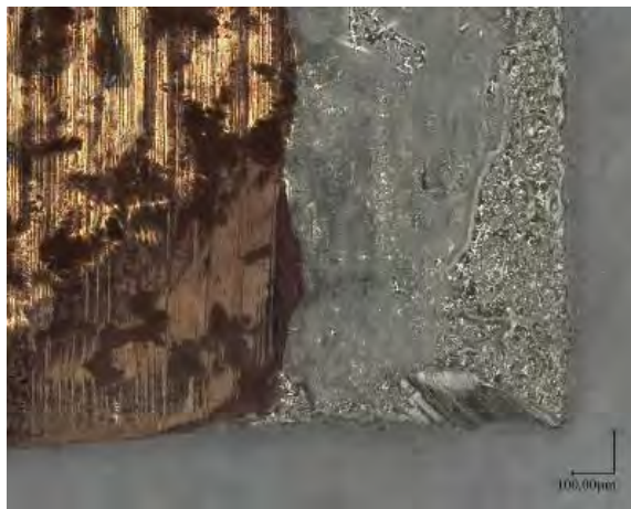
Figure 2.36 – Visualisation au microscope numérique (x200) de l'hétérogénéité du dépôt (a) et de l'aluminium attaqué (b)
