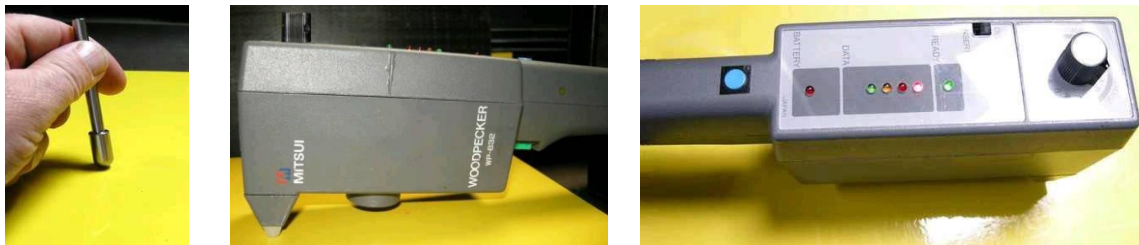
Figure 26 : Tap Test à l'aide d'un simple marteau ou avec un outil spécifique appelé Mitsui Woodpecker. Ce dernier affiche sur 4 LED l'état de santé de la structure. Il compare le son acquis à celui préalablement enregistré [44].
