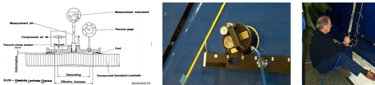
Figure 28 : Technique d'inspection ELCH : mesure d'élasticité [44]
