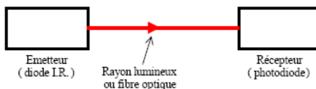
Figure 1-16 : l'utilisation d'une APD dans une chaîne de mesure.
