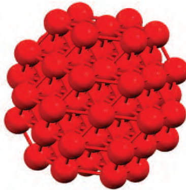
FIGURE 1.14 – Nanoparticule de fer constituée de 59 atomes cristallisant dans la phase cubique centrée.
