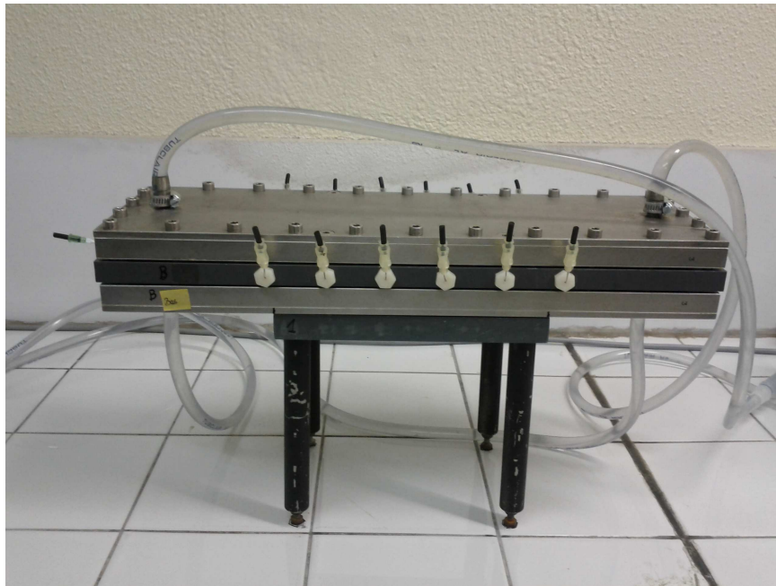
FIGURE 5.5 – (a) Coupe transversale vue de la cellule de thermodiffusion et le dispositif de prélèvement ; (b) Vue extérieure longitudinale de la cellule expérimentale.
