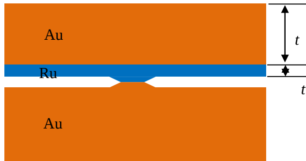
Figure 4.19 Contact avec structure multicouche.
