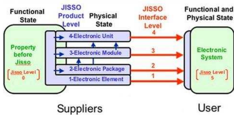
Figure 1.16. Hiérarchisation JISSO des niveaux d'interconnexions, d'assemblage et de packaging système complets pour les produits électroniques [JISSO]. (Bas) Vue schématisée décomposée selon l'état fonctionnel, l'état physique (relatifs aux concepteurs/fabricants), et l'état combiné final (relatif aux utilisateurs du produit). (Haut) Vue matérielle de la hiérarchisation JISSO.
