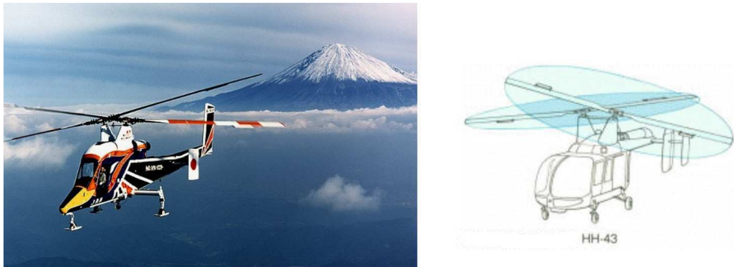
FIG. 1.6: L'hélicoptère bombardier d'eau Kaman K-MAX à double rotor engrené
