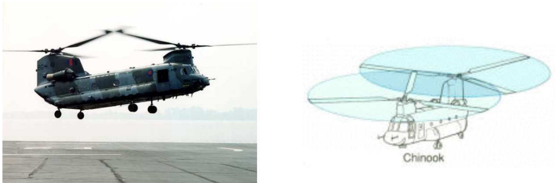
FIG. 1.5: Le Boeing CH47 Chinook à double-rotor en tandem
