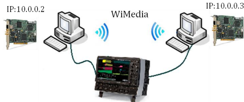
Figure V.15 Capture des signaux PFI sur l'oscilloscope (en sans fil).
