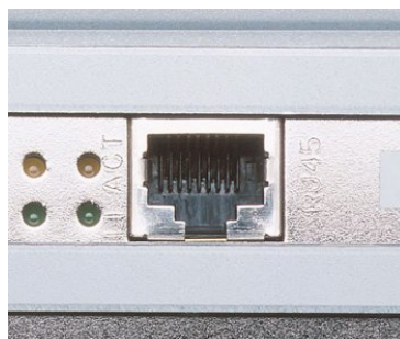
FIGURE 2.8 – Port RJ-45, utilisé pour Ethernet
